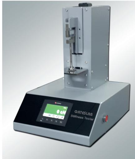
Il est utilisé pour déterminer la dureté des tissus selon la méthode d'essai de la flexion circulaire ASTM. La valeur de mesure maximale est de 50 kgf.
