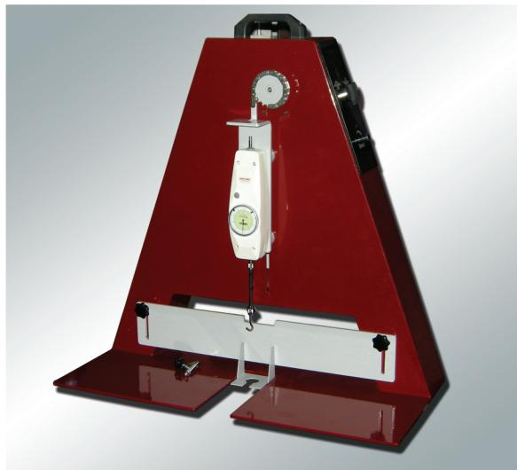
Cet appareil permet de déterminer la force d'adhérence des franges de fils de poils. Il est possible de réaliser la lecture de 20 grammes et des alternatifs de capacité maximale de 5 kg ou 10 kg.
