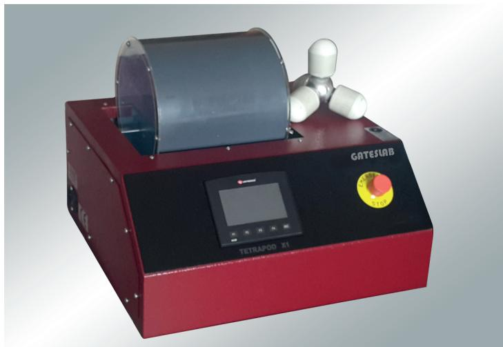
L'appareil de contrôle à tambour tétrapode contrôle la résistance des échantillons au tâchage, leur souplesse et leur allongement.
