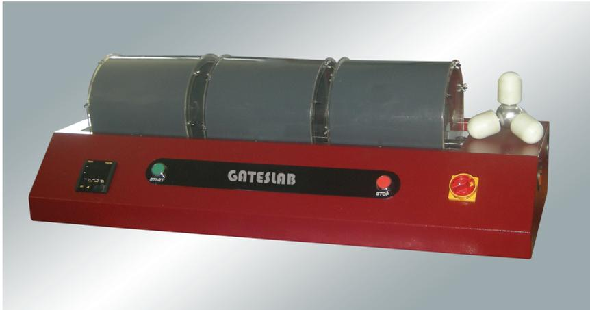
Il est utilisé pour déterminer l'aspect de rétention des revêtements avec ou sans rembourrage, sous-couche par rotation rapide et sûre d'un cube en acier. L'hexapode en acier a 6 pieds en polyuréthane. Il est fourni avec le mécanisme d'inversion, le lot prédéterminé et un compteur. L'hexapode appliquant les taches est utilisé pour répandre la tache de manière correcte et standard. Il est fourni avec le couvercle modifié du tambour, le répartisseur des vibrations et les cylindres de pressage.
