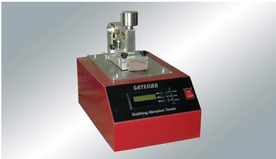
Cet appareil permet de déterminer la résistance de la surface supérieure des matériaux comme le cuir et le tissu face au frottement, évaluer la résistance de la teinture et du traitement et déterminer la sensibilité de la coloration.
