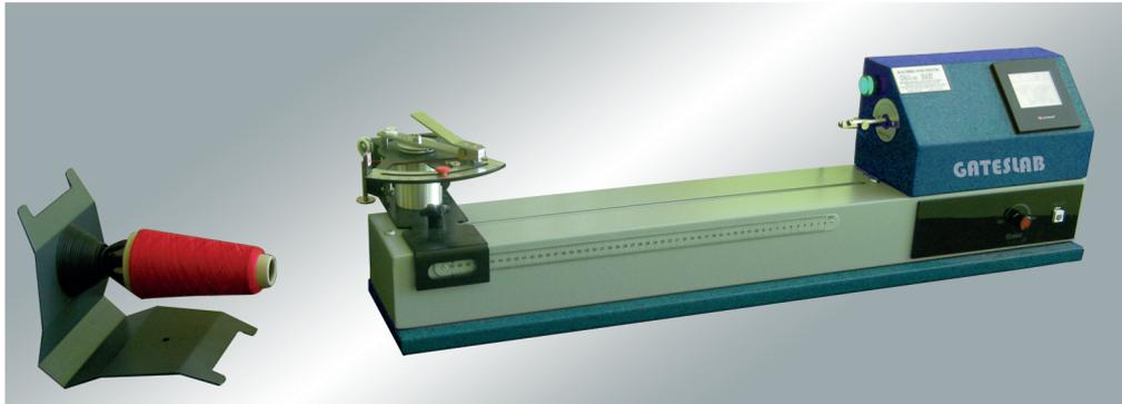
Il est utilisé pour mesurer la torsion des fils à unique ou multi couches. Le module de relevage Open-end est optionnel. Il dispose d'un indicateur numérique et électronique. La torsion peut être réalisée en S et Z. Il peut être ajusté pour une longueur de mesure comprise entre 10 et 500 mm. Il assure une grande précision en prenant la moyenne. La pré-tension peut être calculée sur l'appareil.
