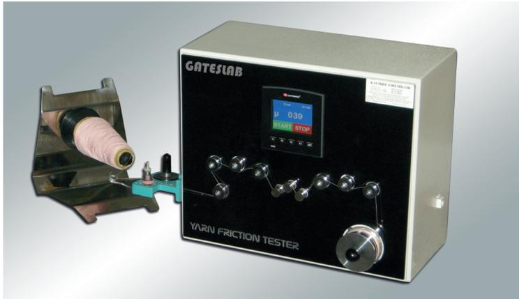
Cet appareil détermine le coefficient de frottement des fils pendant le frottement du métal sur la surface.
