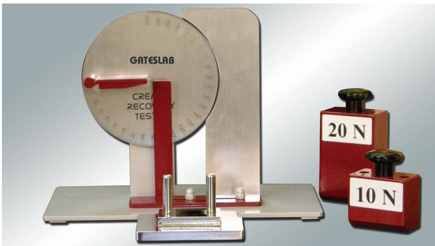
L'appareil est utilisé pour analyser l'angle de correction du pliage du tissu. Selon les normes, il est utilisé pour mesurer l'angle qui se produit après avoir soulevé la pression appliquée sur le tissu plié.
