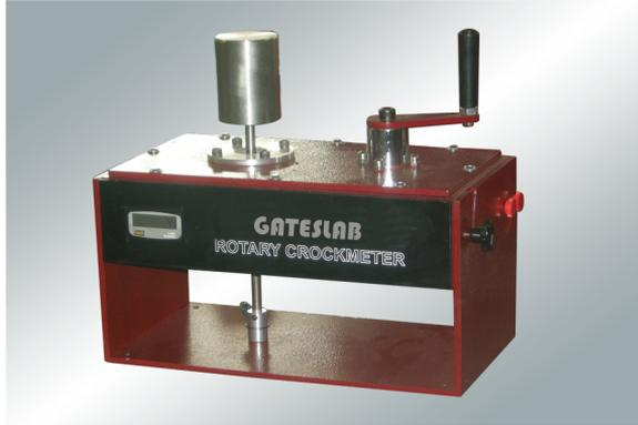
Il est surtout utilisé sur les tissus imprimés pour déterminer la solidité de la couleur et la précision des couleurs, par frottement sec ou humide. Il est capable de tourner dans le sens des aiguilles d'une montre et à l'envers, de 1,125 tour. On applique une pression de 1134 grammes sur l'extrémité de 16 mm de longueur.
