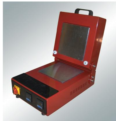
C'est un appareil de contrôle de la sensibilité au repassage qui est utilisé pour déterminer la résistance de tous types de matières textiles et tissus de couleurs face au repassage et le pressage à chaud.
