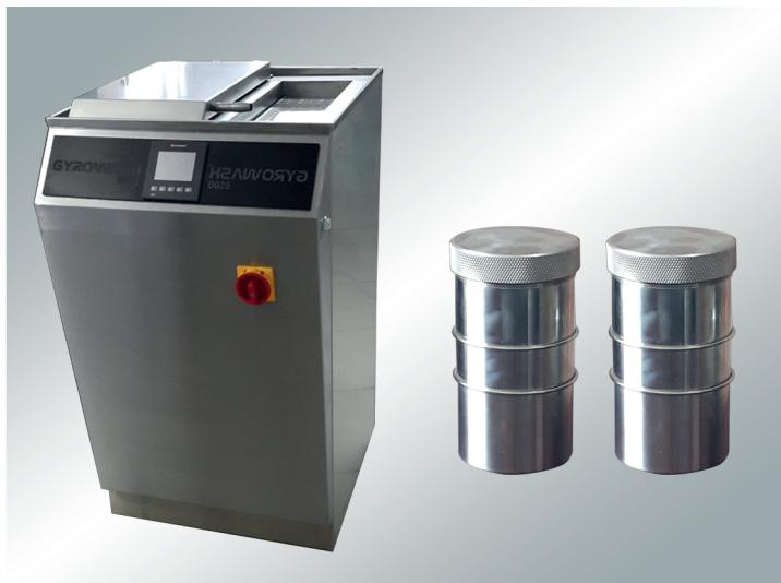
L'appareil est utilisé au sein des laboratoires textiles pour tester les tissus teints disponibles, soumis à la coloration et sensibles au lavage. L'unité de contrôle à microprocesseur fonction à une vitesse maximale de 95°C à 2°C/min.
