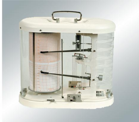
Il est utilisé pour enregistrer la température ambiante et l'humidité relative à un moment prédéterminé sur un graphique. Il peut être réglé pour réaliser des enregistrements durant 1-7-31 jours. 55 papiers graphiques, 3 stylos de marquage et 1 batterie sont fournis.
